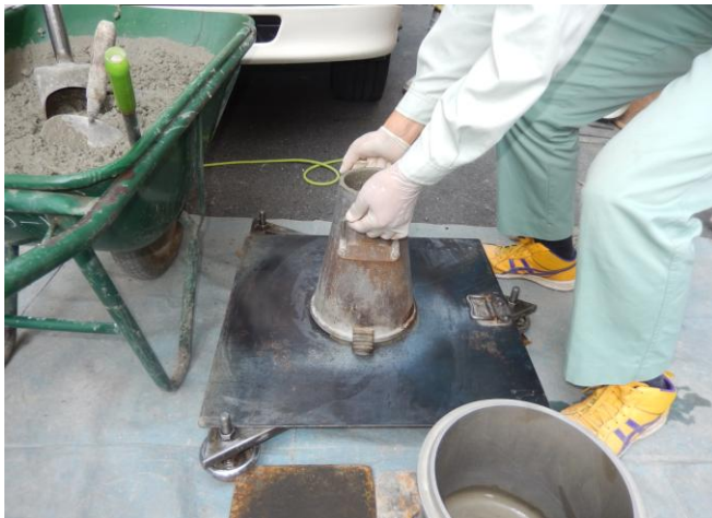
次に、そのスランプコーンを上に引き上げます。この容器の高さは、30 cmです。
