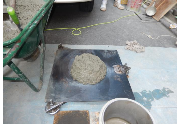
底がない容器なので、中に入っていたコンクリートは、広がっていきます。
