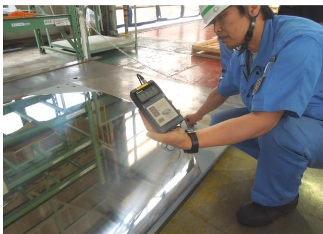
防錆膜厚をチェックしています。 179 \mu\text{m} を示しています。 76 \mu\text{m} 以上であるかが、判定基準なので合格です。
