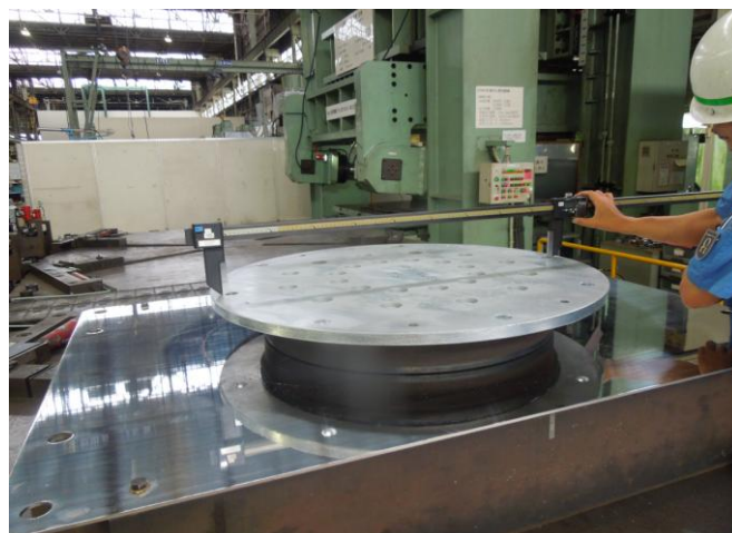
取付ボルト孔ピッチを測定しています。 859.8 mm です。設計値860 mm との誤差1.2 mm 以内ですので合格です。
