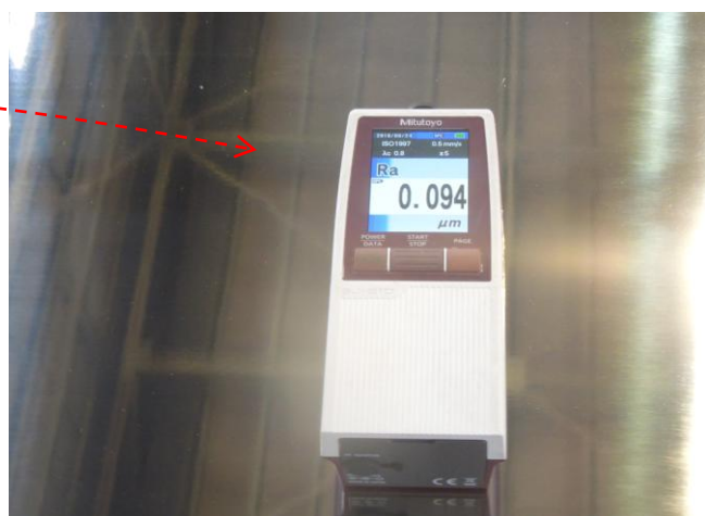
0.094 \mu\text{m} (マイクロメーター) です。判定基準は3 \mu\text{m} ですので、合格です。
