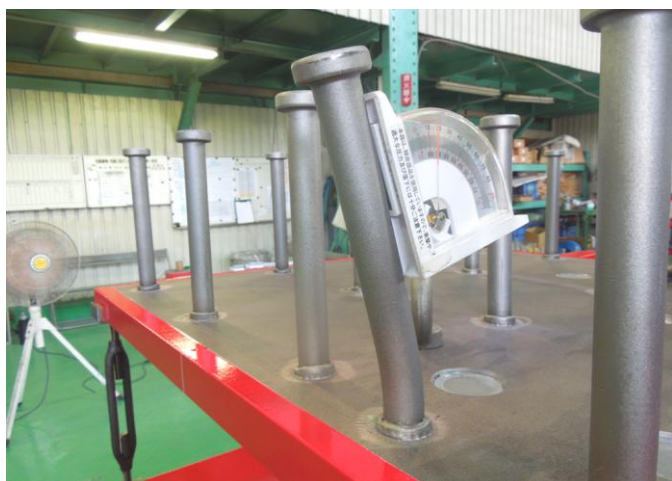
溶接部の異常は見られませんでした。
