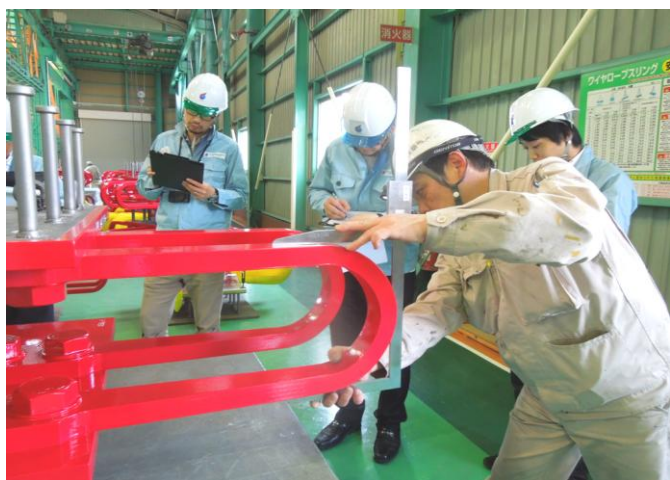
ダンパーの高さを実測しています。 設計値 284 mm に対し、 \pm 10 mm までを 許容値とします。
