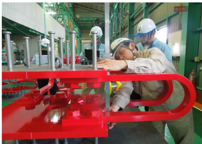
製品の高さを実測しています。 設計値356mmに対し、±10mmまでを 許容値とします。
