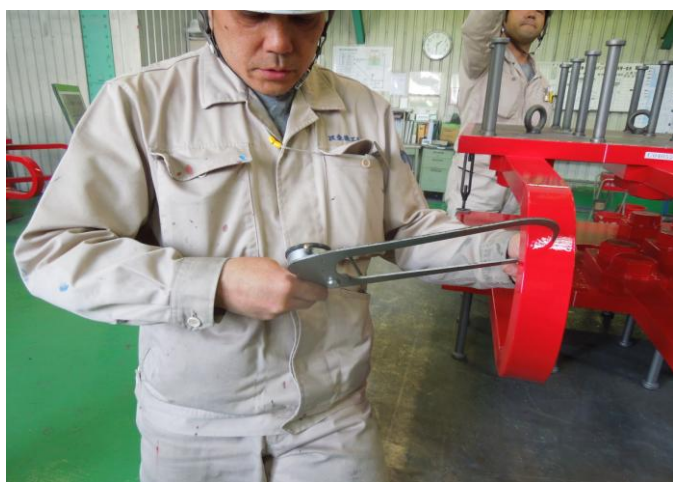
板厚の実測です。 設計値 36 mm に対し、 \pm 1.5 mm までを 許容値とします。
