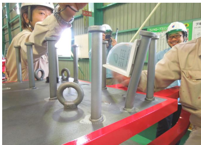
曲げ角度 15^\circ で、溶接部に欠陥が生じないことが判定基準です。
