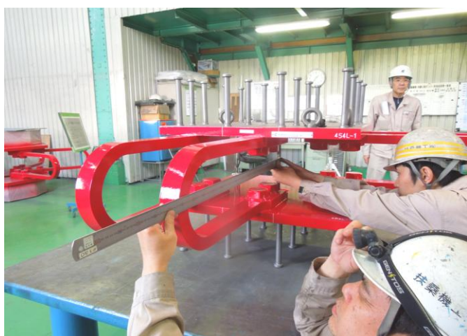
ダンパーの長さを実測しています。 設計値758mmに対し、±10mmまでを 許容値とします。
