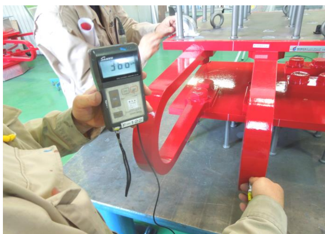
次に「塗膜厚検査」を行いました。 判定基準は、180 \mu m（ミクロン）以上です。
