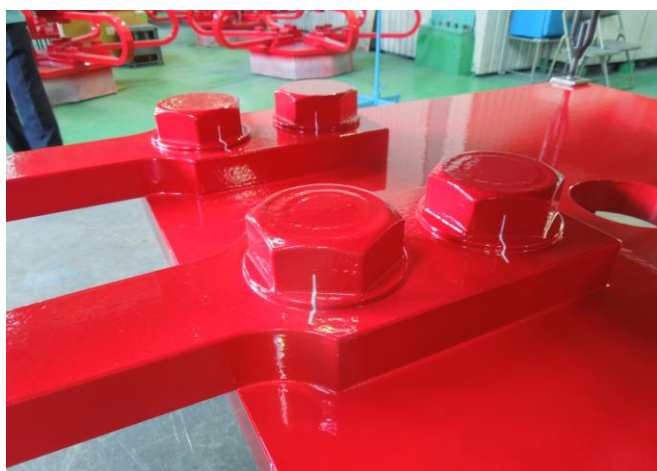
締めたボルトの緩みが生じているかの判断で 白い線を付けています。
