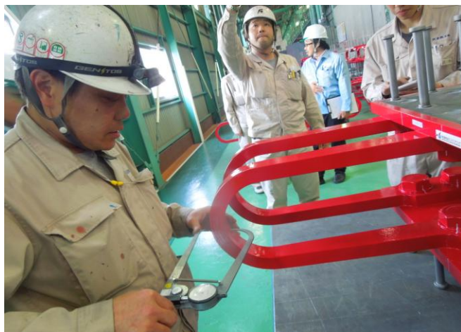
板厚の実測です。 設計値 36 mm に対し、 \pm 1.5 mm までを 許容値とします。
