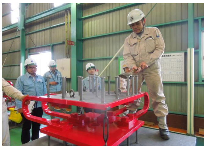
最後に「頭付きスタッド検査」です。 打撃曲げテストの様子です。
